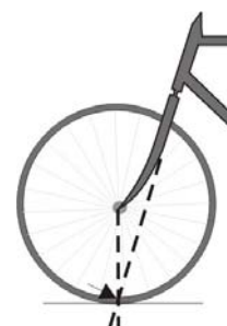
Figura 19 – Ângulo de caída neutro. Fonte: Vespini (apud PEQUINI, 2000)
