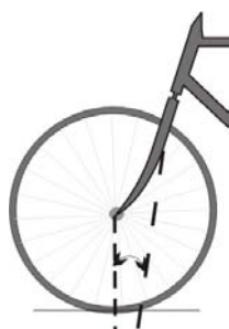
Figura 18 – Ângulo de caída negativo. Fonte: Vespini (apud PEQUINI, 2000)
