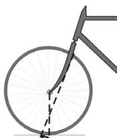
Figura 15 – Ângulo de caída Fonte: Vespini. (apud PEQUINI, 2000)
