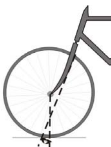
Figura 17 – Ângulo de caída positivo. Fonte: Vespini (apud PEQUINI, 2000)
